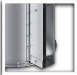
Con lo scopo di garantire le proprietà inossidabili di tutti i componenti e l'accesso alle parti interne della barriera d'aria VARIWIND, la tecnica di assemblaggio è esclusivamente meccanica e non prevede alcun tipo di saldatura. La Lamda d'aria di ciascun modulo è costituito da elementi che permettono la regolazione dell'angolo di lancio in modo da permettere l'ottenimento delle massime prestazioni in qualsiasi condizione.
