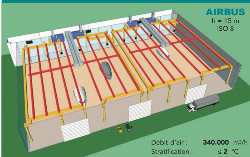
Chaque module d'un mètre, qui compose une gaine perforée **SPIROJET™**, est comparable à un diffuseur traditionnel à très haute induction.
